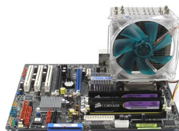
Alaplappal párhuzamos szellőzés
