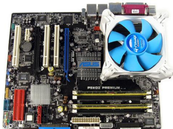
Alaplappal felé irányuló szellőzés
