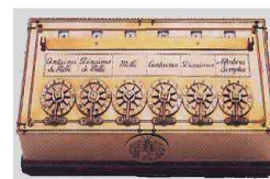
fogaskerekekből álló számológép
