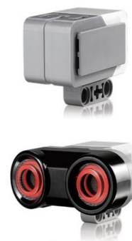
3. ábra. A győro és az ultrasonic szenzor
